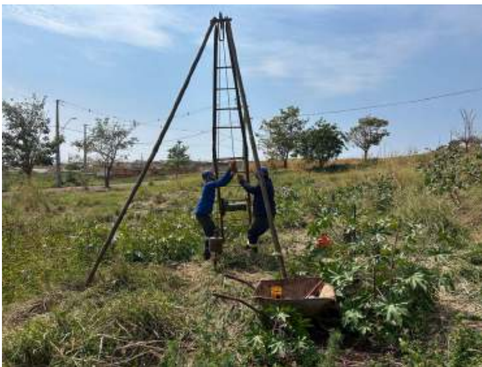
Foto 03 – Perfuração do furo SP-02. Foto Alexandre.
