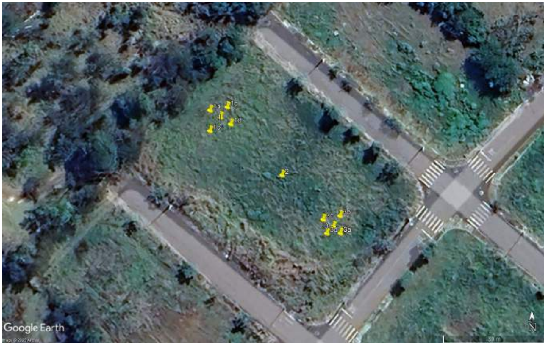
Figura 06 – Posição das sondagens executadas no terreno investigado. Imagem Google Earth, jan/2024.
