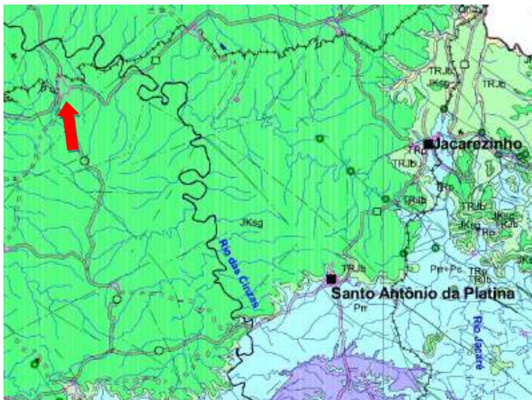
Figura 07 – Mapa geológico do Paraná destacando a cidade de Bandeirantes (seta vermelha). A cor verde (JKsg) representa basaltos da Formação Serra Geral. Fonte Mineropar, ed 2006.
